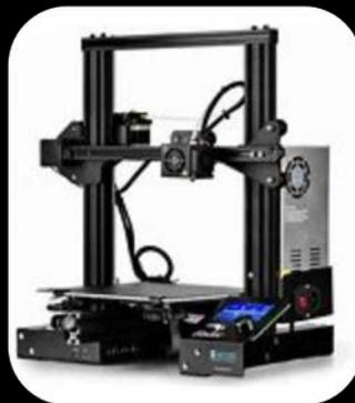
Un modelo digital en 3D se corta en cientos de capas finas mediante un software específico para exportarlo en formato de código G. Este formato de impresión 3D es un lenguaje que la impresora 3D lee para saber con precisión cuándo y dónde depositar el material.
