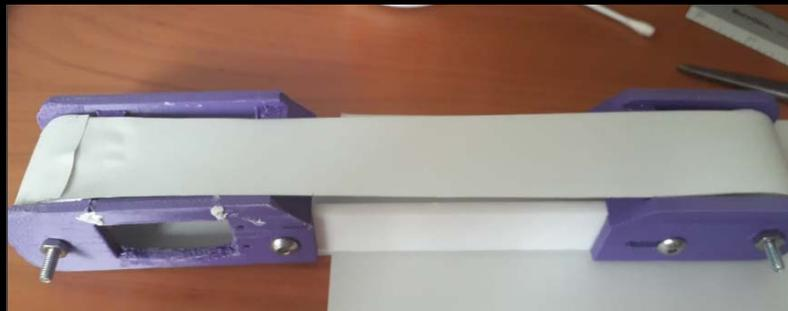
Al momento de probar la banda con el motor a pasos se descubrió que tenía fallas ya que la banda se trababa y no giraba y para resolver eso se tuvo que volver a imprimir algunas piezas de la banda.
