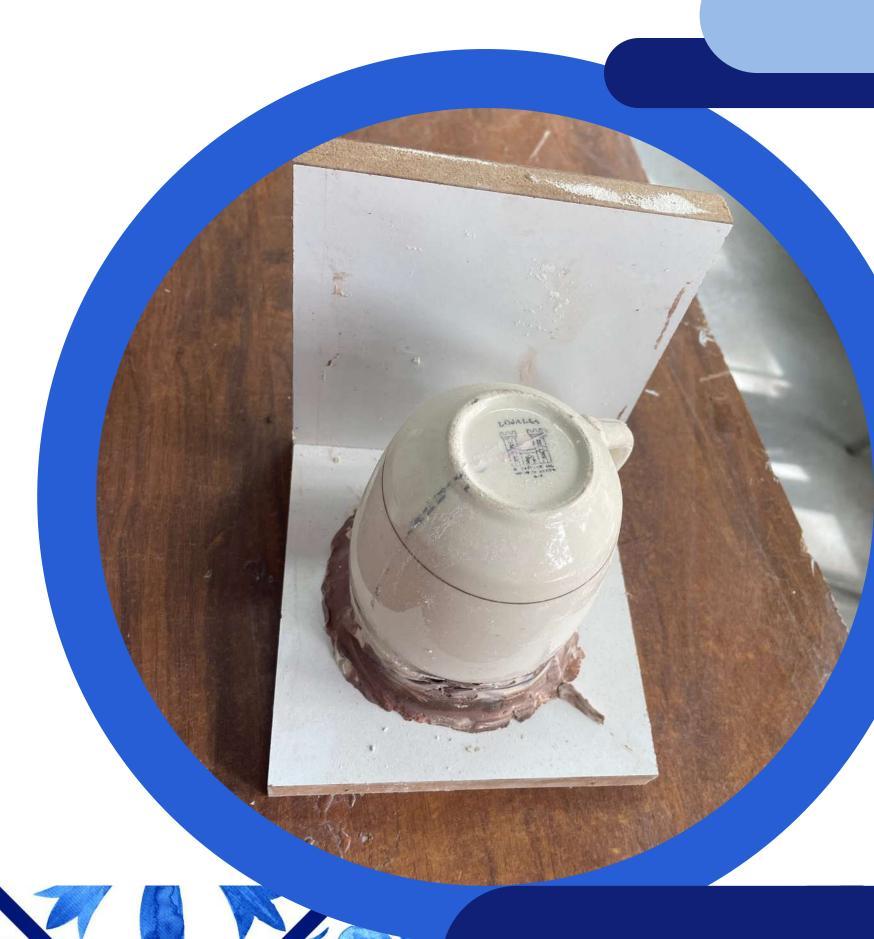
Se realiza la mezcla del yeso con agua para poder realizar el vaciado y lograr el primer tacel.
