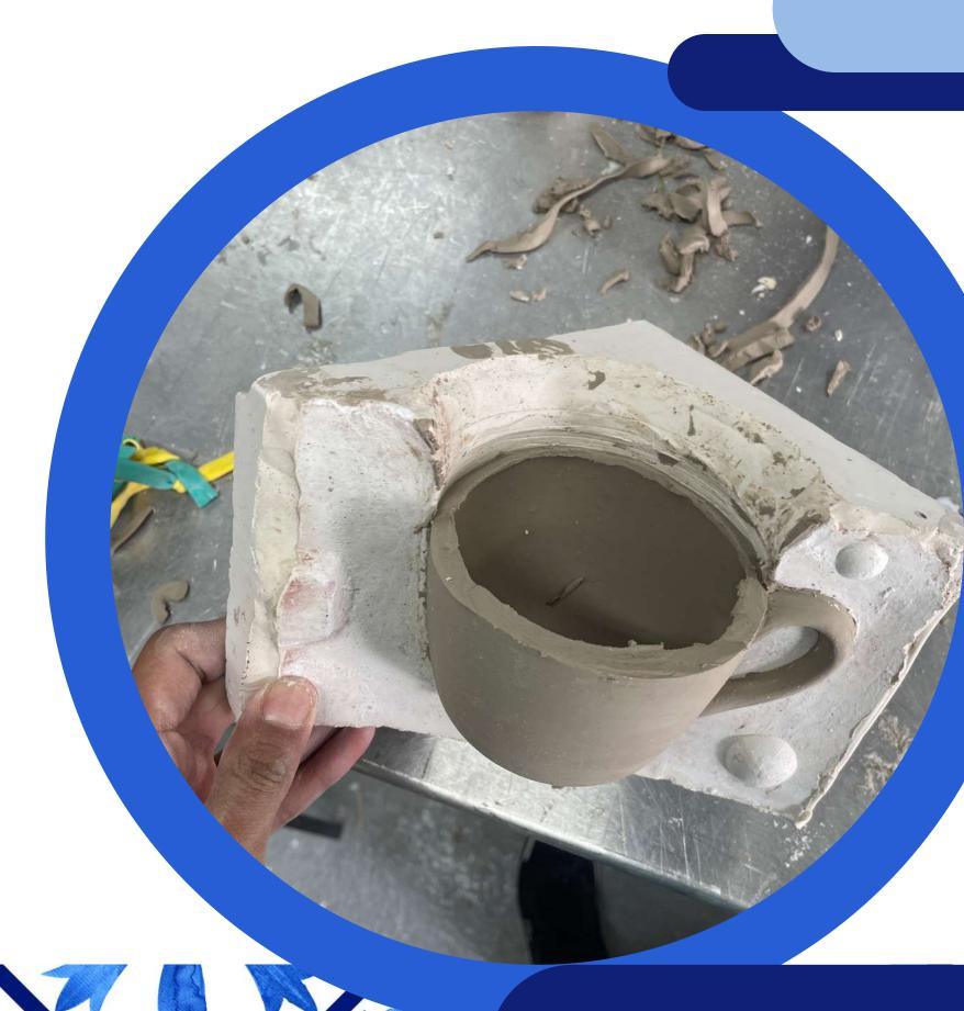
Después de desmoldar se detallan las piezas en este caso se hizo ese paso con lijas delgadas para eliminar bordes no deseados.
