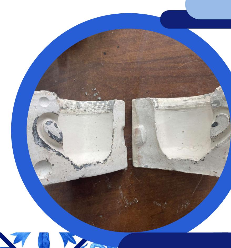
Para este siguiente paso se unen los dos moldes y se refuerzan con algún tipo de elástico en este caso se utilizaron globos para así evitar alguna fuga a la hora de vaciar la barbotina .
